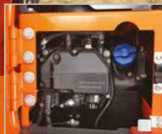
Depósito de reducción catalítica selectiva (SCR)
